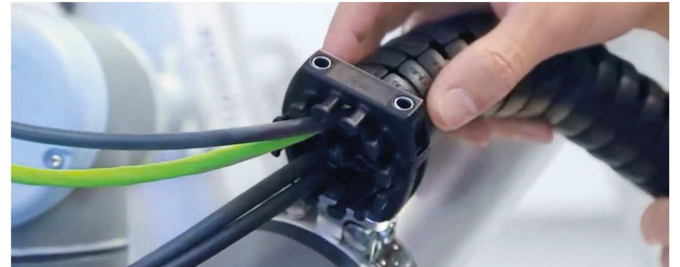
Abb. 18: Installation eines Leitungskanals (6)
